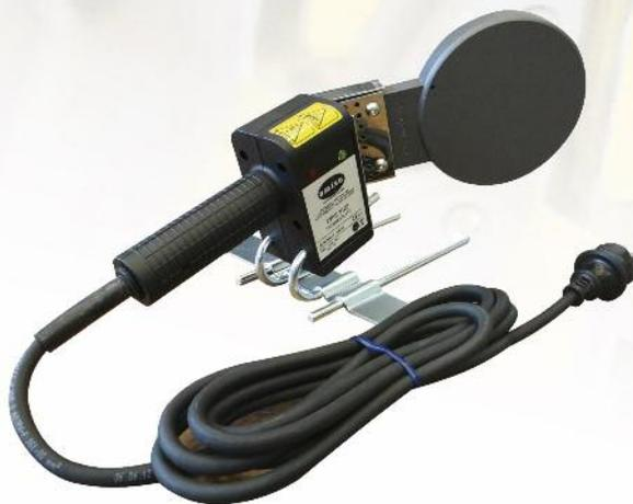
Termoplastra inclinata a 30°, Ø 120 mm, adatta alla saldatura testa-testa di tubi e raccordi in PP-PE ed altri materiali termoplastici. Termoplastra fornita con cavalletto da terra.
