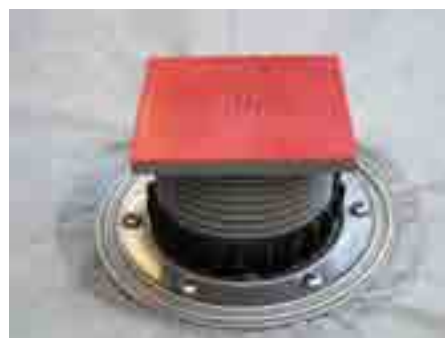
5. Stezaljkom (HL83.0) geotekstil spojiti sa nastavim elementom (HL85N), postaviti drenažni prsten (HL180), Završni okvir sa privremenom građevinskom zaštitom podesiti na visinu krajne obloge
