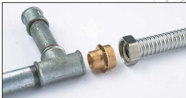
NIPPLE RIDOTTO CON SEDE PIANA PER ACCOPPIAMENTO DI TUBI CORRUGATI A TUBI LISCI FILETTATI FEMMINA SENZA RIDUZIONE DEL PASSAGGIO NOMINALE.
