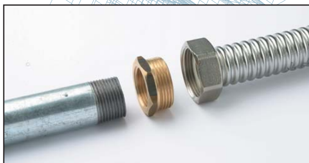
RIDUZIONE CON SEDE PIANA PER ACCOPPIAMENTO DI TUBI CORRUGATI A TUBI LISCI FILETTATI MASCHIO SENZA RIDUZIONE DEL PASSAGGIO NOMINALE.
