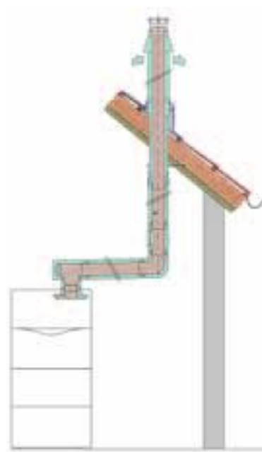
Vertikalno provodenje koncentričnog vazduho-/dimovodnog sistema kroz krov.
