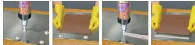
Tačkasto ili trakasto lepljenje na već pripremljenu podlogu.
