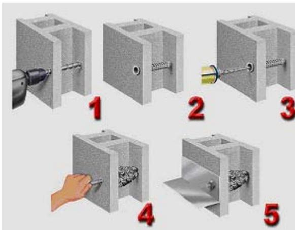
Da bi ste montirali ankere u šuplje materijale (opeke ili blokovi) morate koristiti perforirane cevne umetke.
